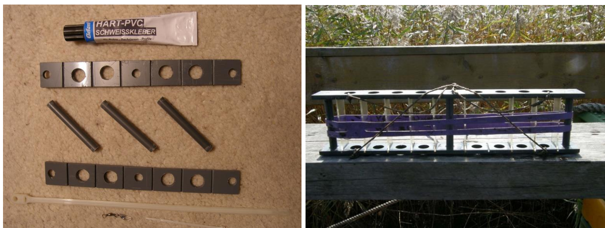
Abb. 1: Bauteile für den Objektträger-Halter, Objektträger -Halter mit Ringgummi-Fixierung im Einsatz.
